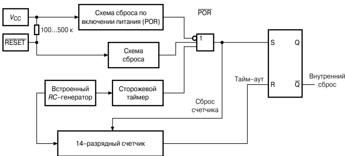
Рис. 4.10. Структурная схема подсистемы сброса микроконтроллера AT90S1200
