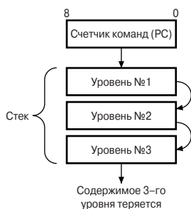
Рис. 2.30. Работа стека при выполнении команды CALL
